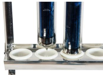
8. Den Behälter um die eigene Achse drehen, damit die Spalten zwischen den Rohren und dem Behälter gleichmäßig sind. Nachdem die Rohre im Behälter montiert wurden, die Silikonichtungen an den Behälterrand pressen.
