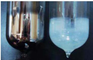
Niesprawną (rozhermetyzowaną) rurę poznajemy po dolnej części. Sprawna rura ma lustrzaną powierzchnię a pozbawiona próżni staje się biała matowa. W przypadku wykrycia usterki wymieniamy pojedynczą rurę wykonując w odwrotnej kolejności czynności 7 – 4.
