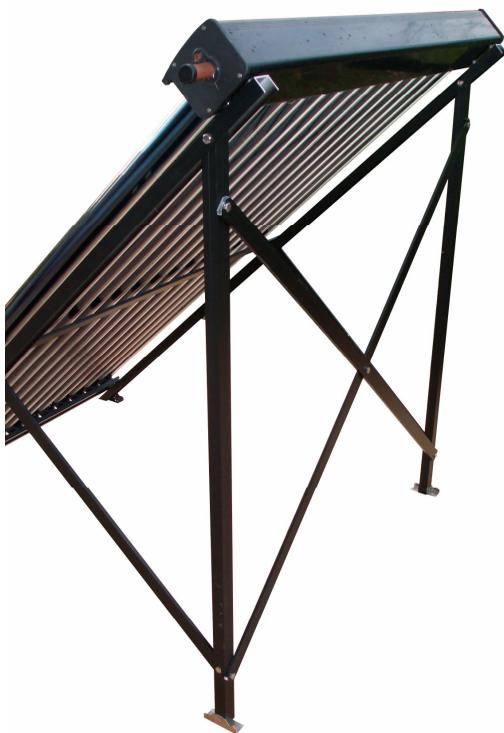
6. Aby konstrukcja mogła stać samodzielnie montujemy dwie poprzeczki stabilizujące konstrukcję (elementy **5**) – łączniki pomiędzy nogami przednimi oraz tylnymi. Łączniki montujemy od wewnętrznej strony profili nóg. Łącznik powinien być zamontowany w taki sposób, aby koniec ścięty pod kątem 90 st. znajdował się wewnątrz przedniej nogi, natomiast koniec ścięty pod kątem 45 st. Wewnątrz tylnej nogi.
